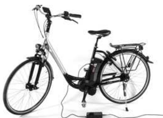
SITZROHRBATTERIE Aufladen der Batterie
